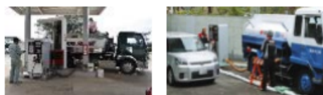
移動タンク貯蔵所と可搬式給油設備を接続した例
