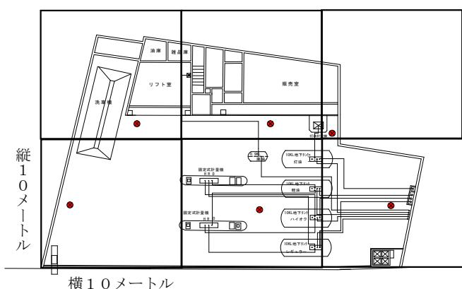
ロ 土壤汚染対策法施行規則第4条の試料採取等を行う区画の選定を準用して、例えば申請給油所を10メートルの区画に
